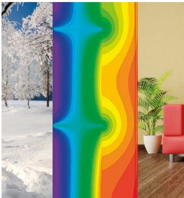
Abb. 1: Ausgeprägte Wärmebrücke bei Aluminiumkonsolen
