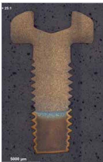
Härtezonen im Querschliff einer duoHARDtip® Spiralförmige Schraube
