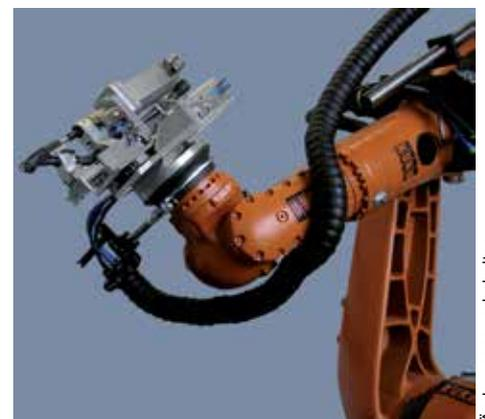
Roboterassistiertes Schraubsystem der Firma Weber Schraubautomaten
