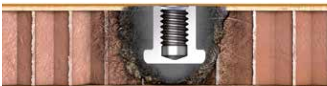
TSSD® Aero mit UNJC/UNJF-Insert in Waben-Sandwichstruktur
